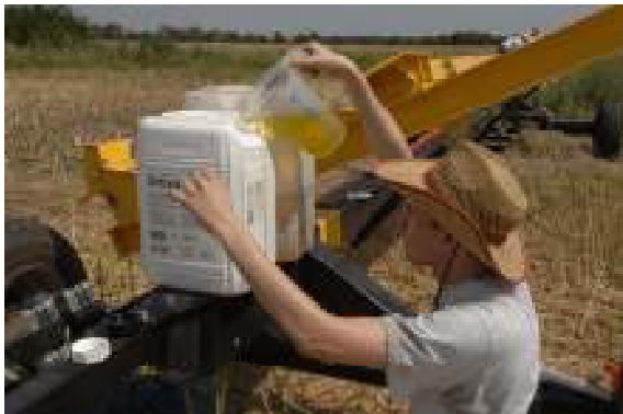
Auslitern des Kraftstoffverbrauchs
